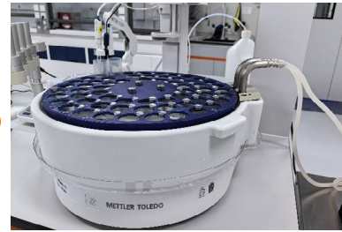
引入自动进样机后可实现连续测试
